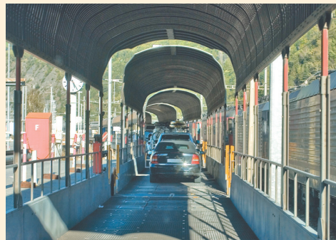
Мал. 200. Чыгуначныя платформы для перавозкі аўтамабіляў у тунэлі Сімплтан
